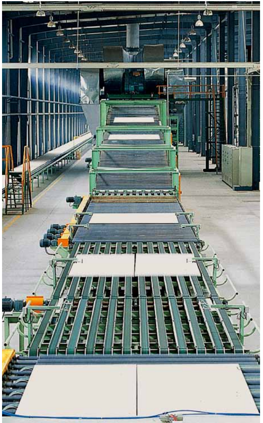
由燃煤电厂烟气脱硫石膏为原料生产出纸面石膏板
