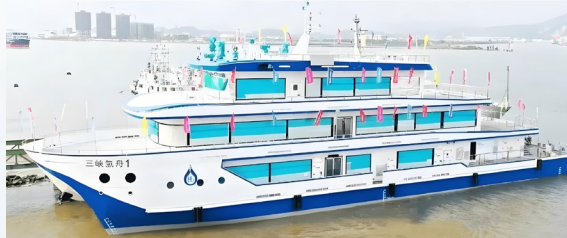
苏州有限自主研发的 32 只船级社认证 320L 氢气瓶，用于国内首艘入级中国船级社（CCS）的 500kW 氢燃料电池动力工作船“三峡氢舟 1 号”，并成功下水。
